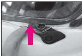
Para cerrarla completamente, presione la visera hacia abajo hasta que el perno del pestillo se enganche y la palanca trabe la parte inferior de la visera.
