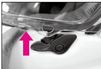
**ADVERTENCIA:** No intente abrir la visera sin utilizar el sistema de cierre, ni empuje hacia abajo la palanca de la traba de la visera, ya que podría dañarse el sistema.
