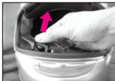
Para instalarlo, inserte primero el centro del deflector en la ranura receptora y luego presione los lados desde el centro hacia afuera.
