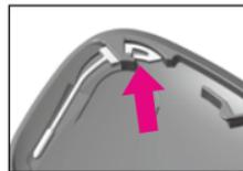
Tire del anclaje para retirarlo de la ranura.
