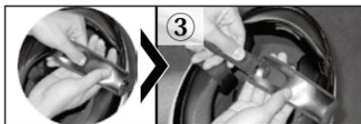
Coloque la cubierta de plástico del anclaje de la correa del mentón sobre el anclaje de acero y presione hasta que la lengüeta de la parte posterior de la cubierta quede correctamente instalada ④.
